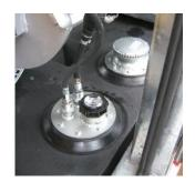
Kraftstofftank Korrosionsfreier 140 Liter Kraftstofftank aus Polyethylen (HDPE), im unteren Teil des Tankrahmens positioniert.
